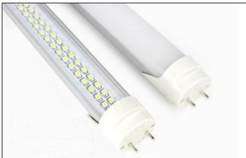
LED-Tubes sind Leuchtkörper die in Form und Abmessungen den herkömmlichen T8-Leuchstofflampen gleichen, jedoch mit einer Vielzahl an LED-Chips ausgestattet sind. Die Umrüstung ist mit relativ geringem Aufwand realisierbar. Es müssen lediglich die Leuchtmittel ausgetauscht und der vorhandene Starter ausgedreht und gegen einen LED-Starter ausgetauscht werden.
