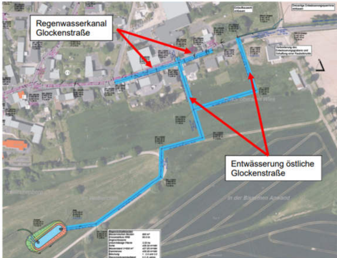
Verlegung eines RW-Kanals in der Glockenstraße bis zum geplanten RRB südlich der Ortslage
